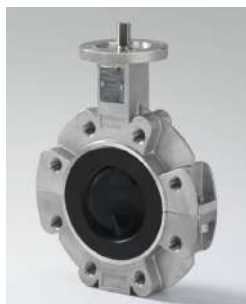
Lug 1.4408 (CF-8M) PTFE-AS/PFA-AS, fri spindel
